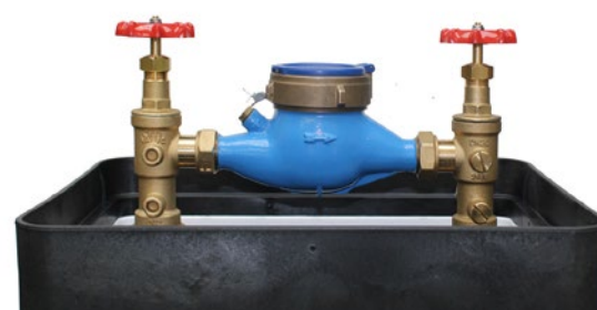
MODULO 1SV A / MODULO 1V A: Ventil před i za vodoměrem, včetně zpětné klapky s odvzdušněním za vodoměrem, pro vodoměr DN20 (závit 1")
